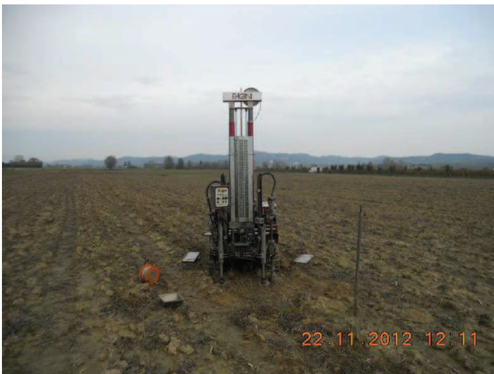
Figura 2: Prova penetrometrica CPT2
